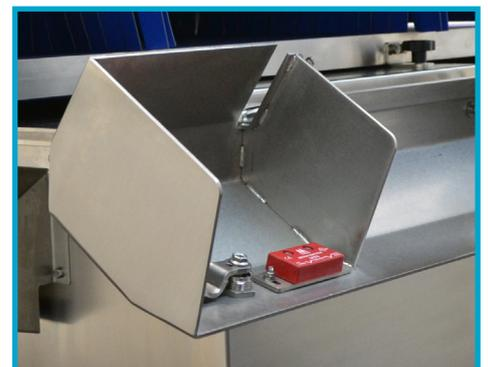
Verschließbare Abdeckungen mit Sicherheitsschaltern verhindern die Erzeugung von Röntgenstrahlung bei geöffneten Abdeckungen
