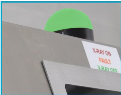
Eine Rundum-Statusleuchte zeigt deutlich an, wenn Röntgenstrahlung erzeugt wird
