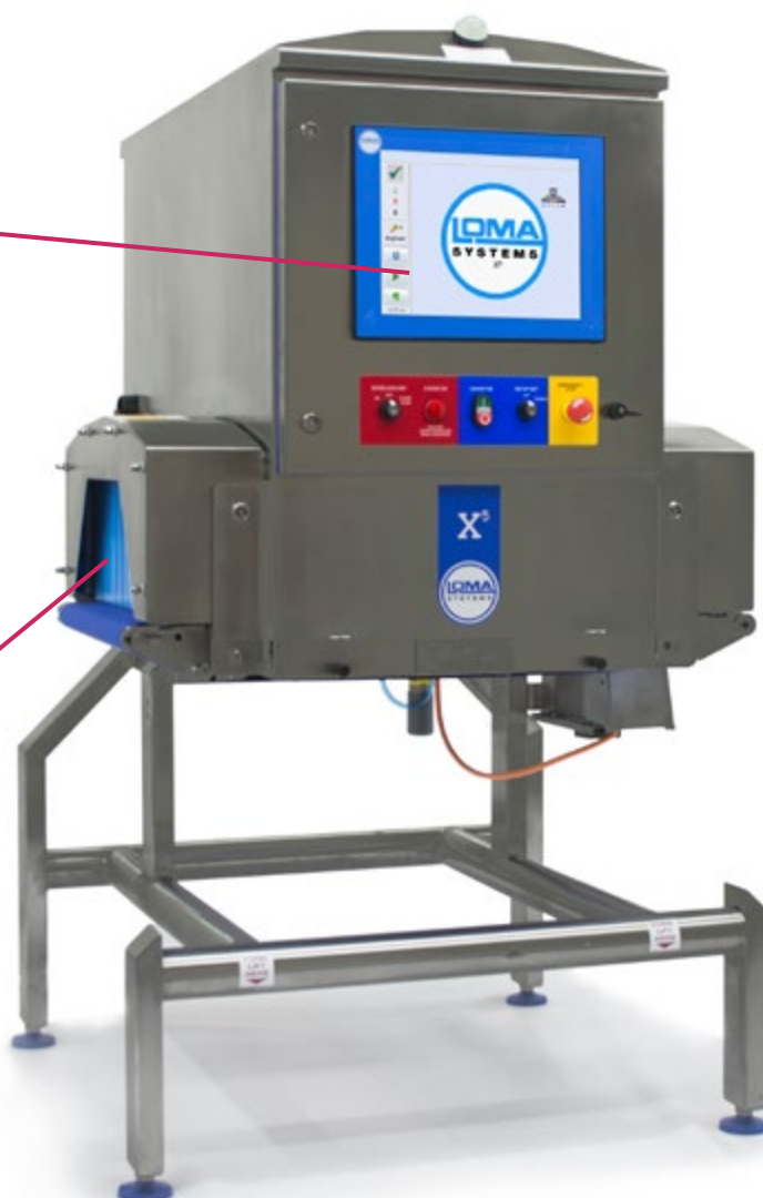
Detectie van metaal, glas en steen in chocolade-eieren gewikkeld in aluminium folie
