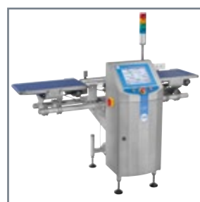
CW3 Draglink is ontworpen voor het wegen van blikken of flessen en kan snelheden behalen van wel 115 m/min
