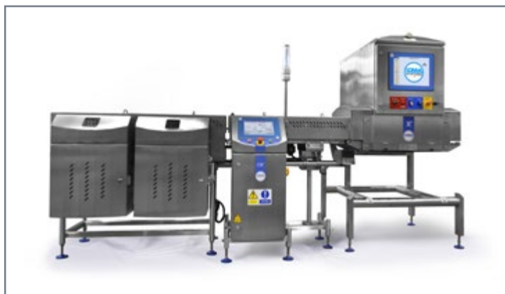
Kombinovaný systém rentgenové kontroly X5 SpaceSaver a kontrolního vážení CW3
