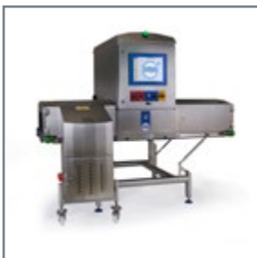
Systém rentgenové kontroly X5 Pack včetně vyřazovací stanice je navržen pro kontrolu balených výrobků až do hmotnosti 25 kg
