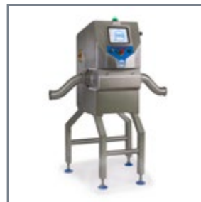
Systém rentgenové kontroly Pipeline je určen pro kontrolu volně protékajících produktů jako např. masových směsí nebo polévek a vyniká při odhalování úlomků kostí
