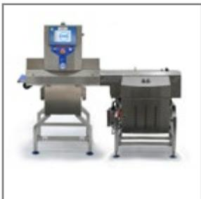
Rayons X type X5c avec station de rejet et conforme aux spécifications des normes en vigueur
