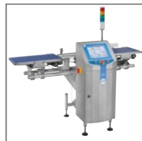
CW3 Draglink est conçu pour les boîtes ou bouteilles et peut atteindre des vitesses de pesage de 115 m/min
