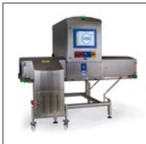
Rayons X type X5 Pack avec station de rejet, conçu pour des produits emballés pesant jusqu'à 25 kg
