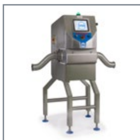
Rurowy system kontroli rentgenowskiej X5 przeznaczony jest do kontroli płynnych i półpłynnych produktów pompowanych rurami (takich jak farsze mięsne, sosy, zupy itp.) i może służyć do wykrywania fragmentów kości.
