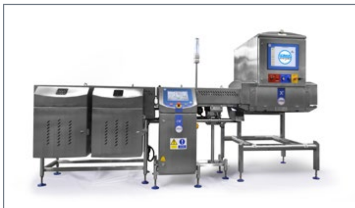
System Combo - system RTG X5 SpaceSaver i waga kontrolna dynamiczna CW3
