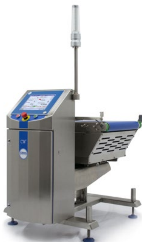
Waga kontrolna dynamiczna CW3 do produktów bardzo ciężkich (do 60 kg)
