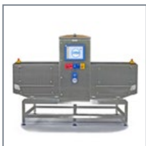
System RTG X5 XL służy do kontroli dużych produktów, np. mięsa w pojemnikach typu „euro”.
