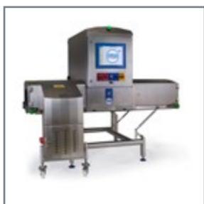
System RTG Loma X5 Pack z wbudowanym systemem odrzutu zaprojektowano do kontroli produktów zapakowanych.
