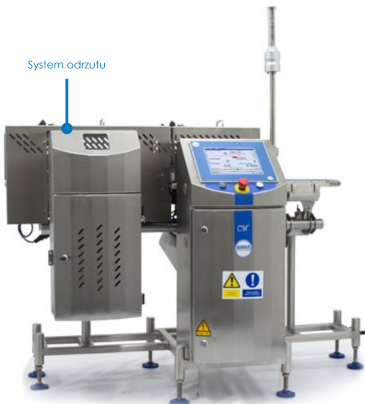
Waga kontrolna dynamiczna CW3 do produktów o średniej wadze (do 6 kg)
