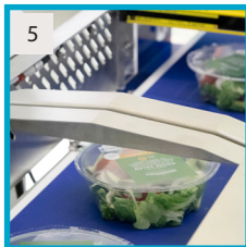
5 Odnímatelné kryty se světelným bezpečnost- ním závěsem
